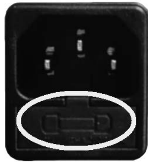
Fig. 36 - Abdeckklappe mit Sicherungen, die ausgewechselt werden müssen
