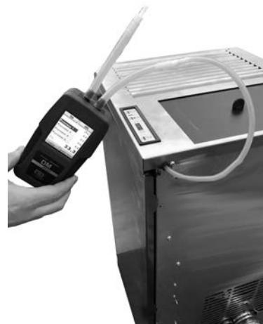
Fig. 27 - Anschluss des Digitaldruckwächters
