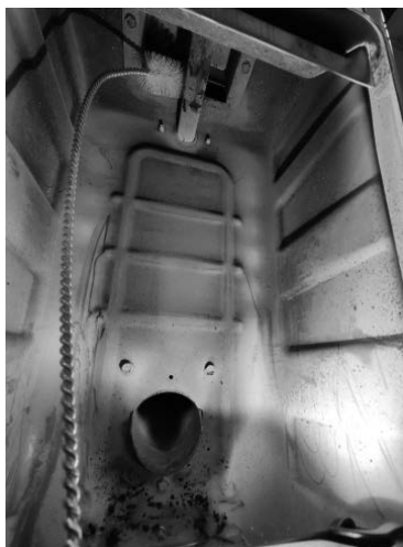
Fig. 33 - Mit einer Rohrreinigungsbürste reinigen
