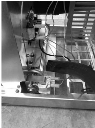
Fig. 35 - Reinigung Raumventilator
