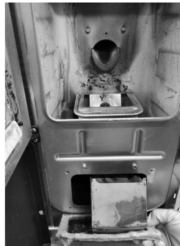
Fig. 30 - Den Inspektionsstopfen entfernen
